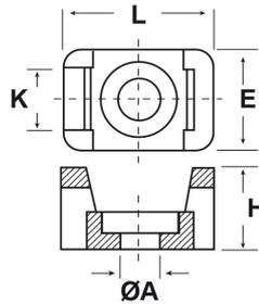
Basette per fissaggio con vite
